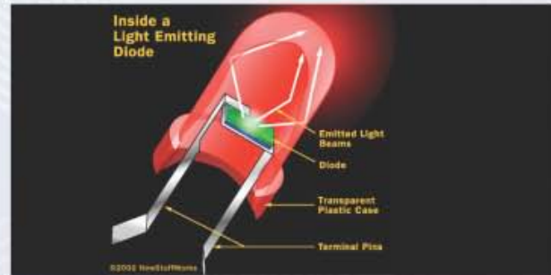
شكل (٢) المكونات الداخلية لـ "لد"
